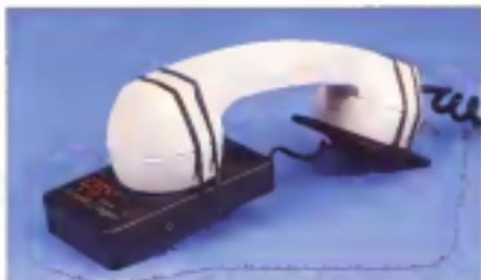
L'accoppiatore acustico Discovery 2100U in versione speciale: il cavoetto telefonico è ancorato piuttosto saldamente mediante dei perni di plastica.
